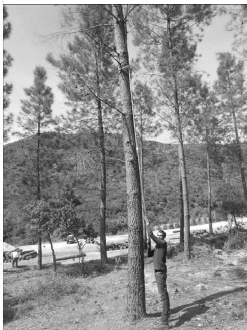
Figura 2. Utilizzo del “cavalletto finlandese” nella misurazione di un diametro in alto.
