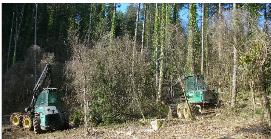
Figura 7.1 – Diradamenti di pino nero - Monte Morello (FI), harvester e forwarder .
