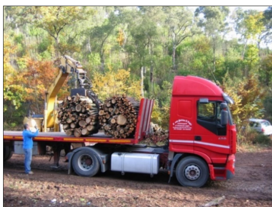
Figura 7.6 – Carico dei fasci di legna su auto-articolato con gru idraulica.
