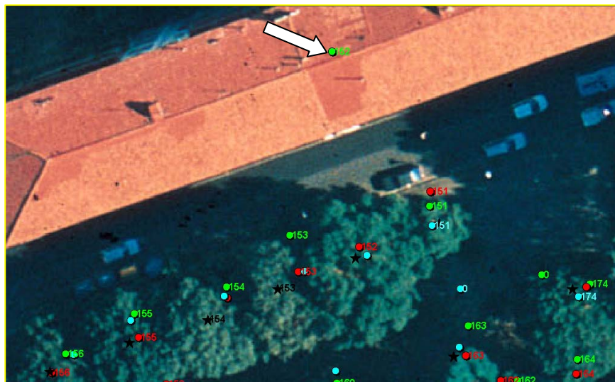
Foto 11.4 Esempio di localizzazione errata da effetto Multipath
