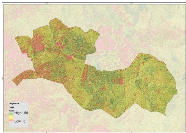
Figura 1 - Modello digitale delle chiome ( Canopy Height Model - CHM) con una risoluzione di 1 metro rappresentante l'altezza degli alberi rispetto al suolo. Le linee bianche rappresentano i confini delle particelle del Silvomuseo.
