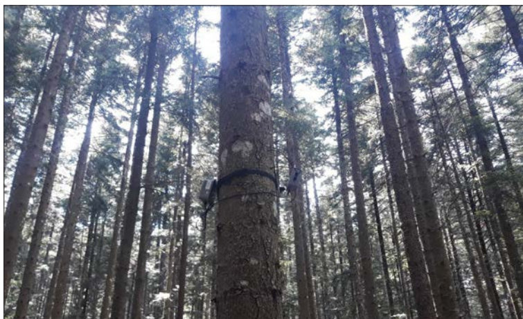
Figura 1 - Dispositivo TreeTalker montato su individuo di Abies alba nella Riserva di Vallombrosa.
